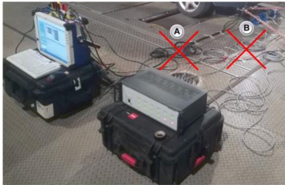
(A) 电压电缆和 (B) 电流电缆应分开且不卷起，以减轻电磁干扰产生的噪声
