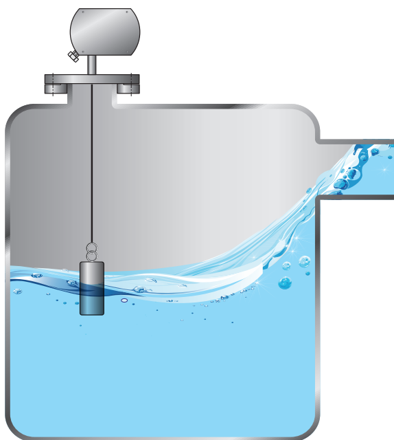
产品应安装在远离进料口的地方，以免发生故障。
